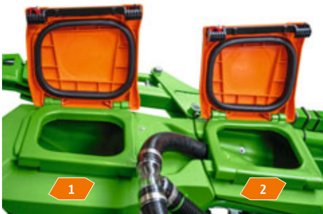
Extra behållare på varje rad för 1) mikrogranulat och 2) frösådd
