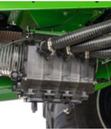
Utmatningsenhet under den centrala utsädesbehållaren
