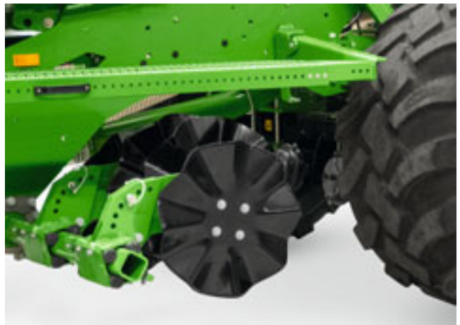
Mekanisk höjjustering av det korrugerade tallrikshjulets markutjämnare
