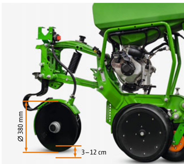
FerTeC twin-gödselbill med bladfjäder-överbelastningsskydd Utläggingsdjupet kan ställas in på 3–12 cm, maximalt billtryck är 80 kg
