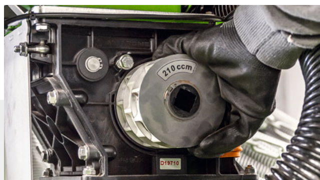
Enkelt byte av utmatningsvals
