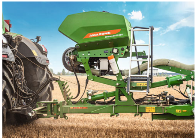
GreenDrill 501: Med en behållarvolym på 500 l och hydrauliskt driven fläkt, för alla bogserade maskiner
