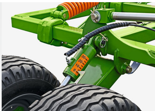
Skala för hydraulisk inställning av arbetsdjupet för pinnarna
