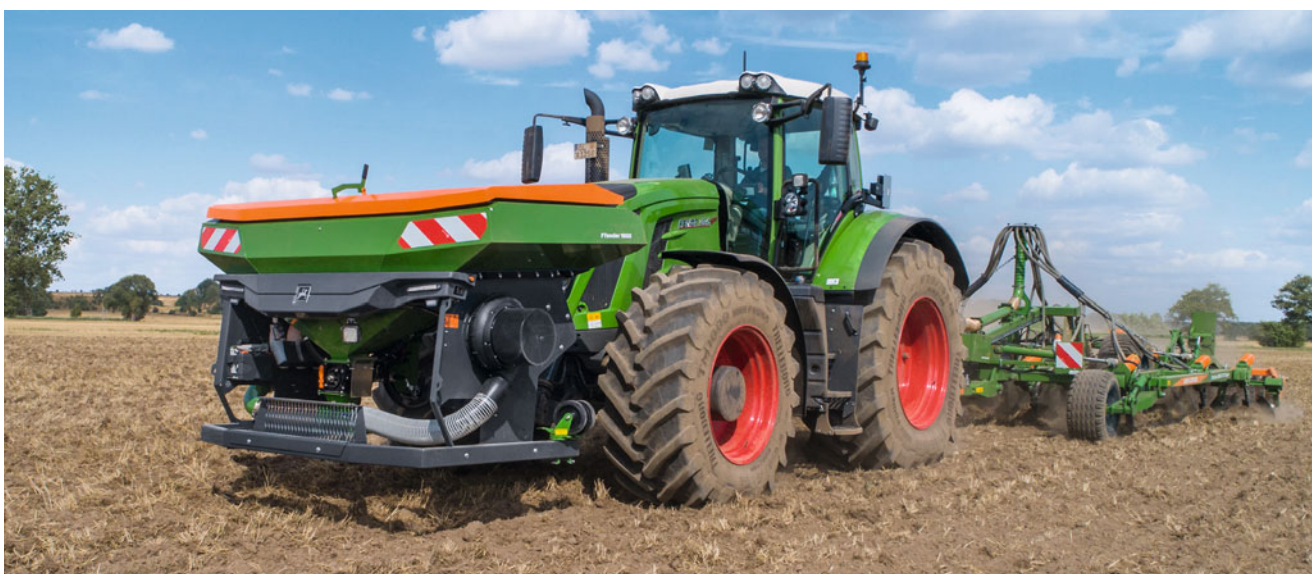
Fronttank FTender 1600 med en behållarvolym på 1 600 l i arbete med Cenius 5003-2TX
