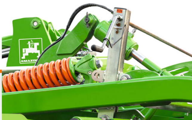
Vantskruvar för central inställning av utjämningsenheten på Cenius-2TX
