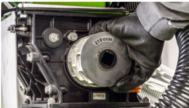
Enkelt byte av utmatningsvals
