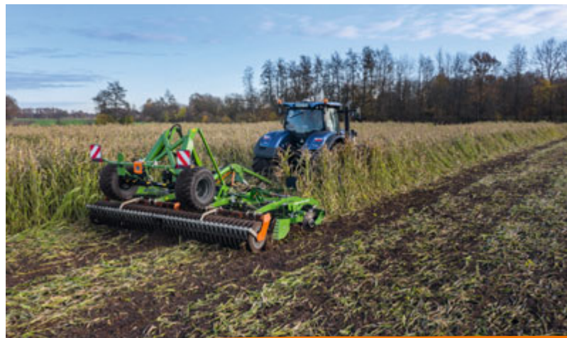
Catros XL 5003-2TS med frontmonterad knivvals
