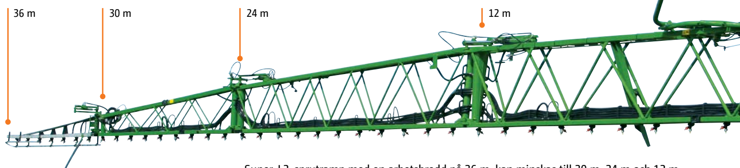
Super-L2-sprutramp med en arbetsbredd på 36 m, kan minskas till 30 m, 24 m och 12 m
