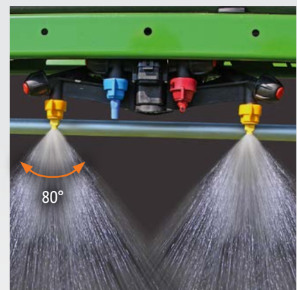
Elektrisk munstycksväxling AmaSelect med fyrfaldig munstyckshållare och 50 cm eller 25 cm munstycksavstånd
