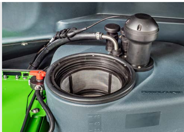
DirectInject-tank med integrerad sil för enkel och säker påfyllning
