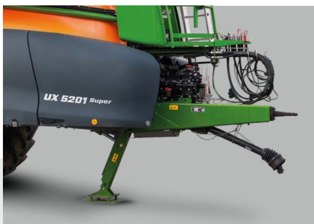
Tillkoppling upptill med dragögla och hydraulisk stödfot
