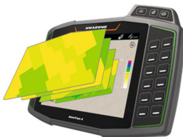
AmaTron 4 möjliggör samtidig användning av upp till 4 olika applikationskartor
