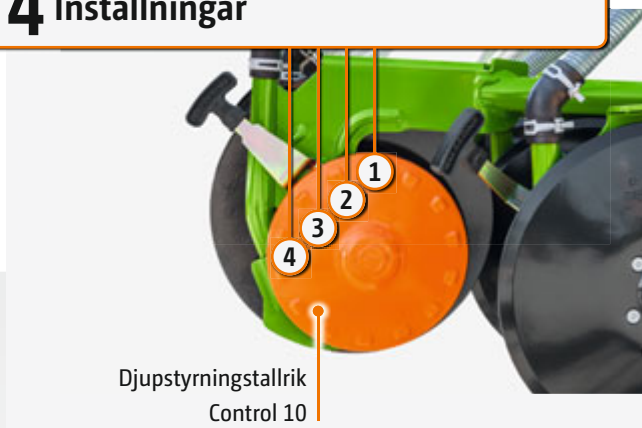
RoTeC pro-bill med djupstyrningstallrik Control 10
