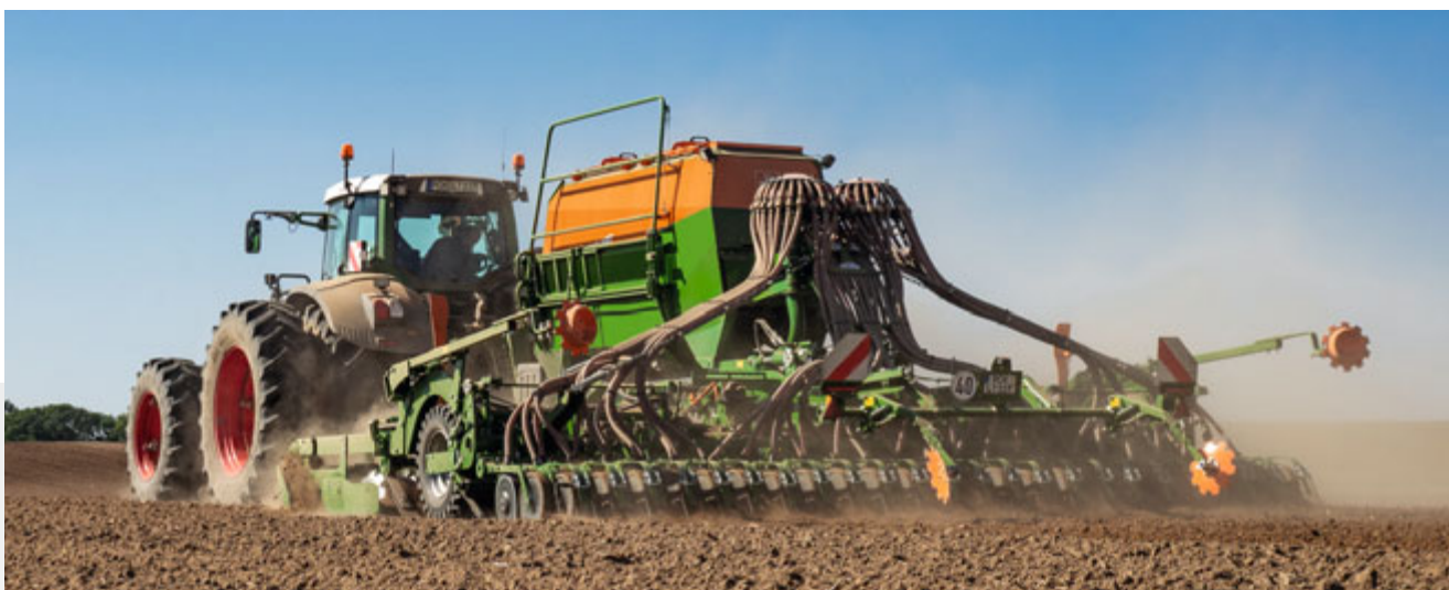
Användning av knivvalsen för att skapa en såbädd med finjord för vetesådd
