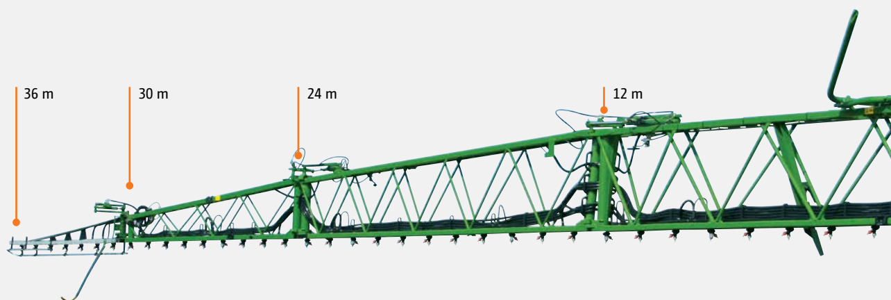
Super-L2-sprutramp med en arbetsbredd på 36 m, kan minskas till 30 m, 24 m och 12 m
