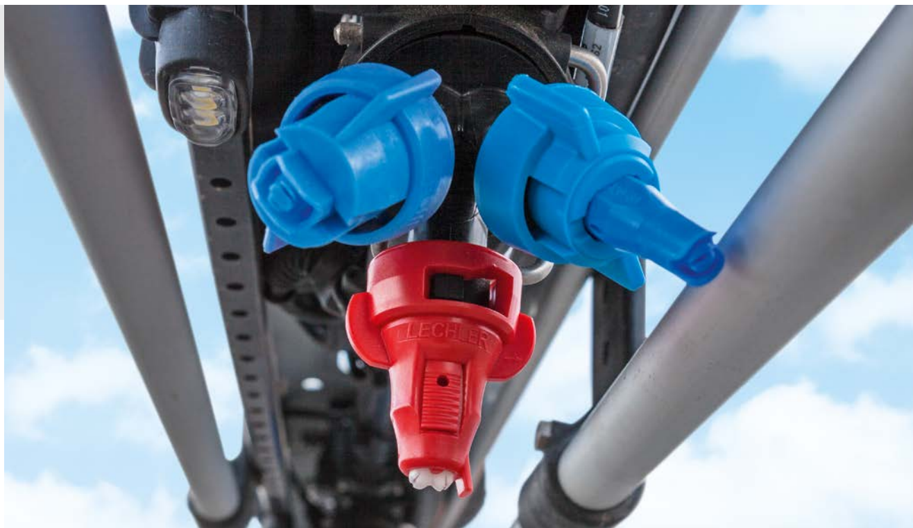
AmaSwitch tripplett munstyckshållare med LED-munstycksbelysning
