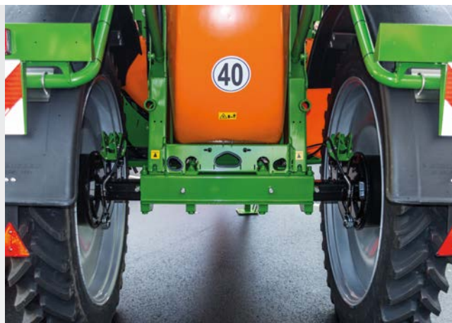
Justerbar axel med steglös spårviddsinställning från 1,50 m till 2,25 m för UX 4201
