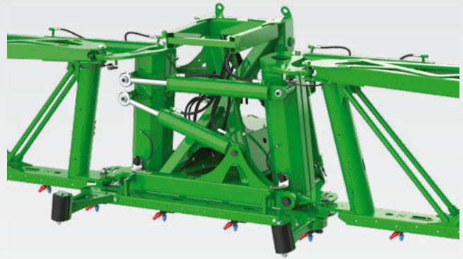
Svängningsdämpning för L3-sprutramper från 39 meter
