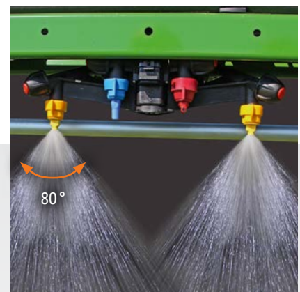
Elektrisk munstycksavstängning AmaSelect med fyrfaldig munstyckshållare och 50 cm resp. 25 cm munstycksavstånd
