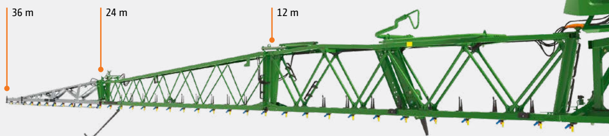
Super-L3-sprutramp med en arbetsbredd på 36 m, kan minskas till 24 m och 12 m
