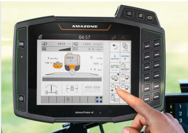
Aktivering av DirectInject i manöverboxen AmaTron 4
