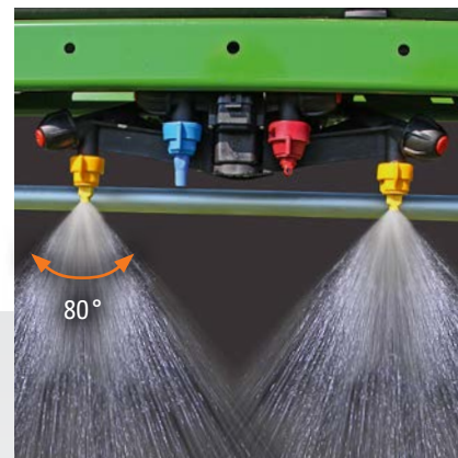
Elektrisk munstycksväxling AmaSelect med 4-faldig munstyckshållare och 50 cm resp. 25 cm munstycksavstånd
