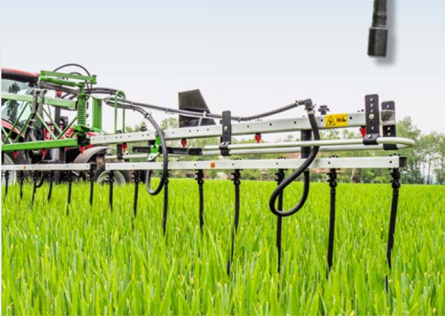
Släpslangar på Super-S2-ramp
