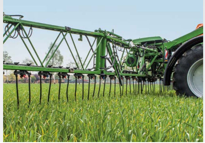
Släpslangsutrustning med 4-faldig AmaSwitch på Super-L2-rampen
