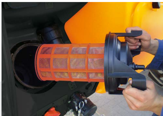
Sugfiltret kan med full maskin öppnas och rengöras utan att sprutvätskanspill ut.
