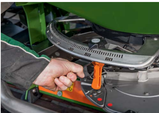
✔ Mekanisk justering av nedsläppssystemet
