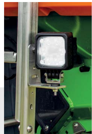
När arbetsbelysningen lyser permanent har den önskade mängden uppnåtts.
