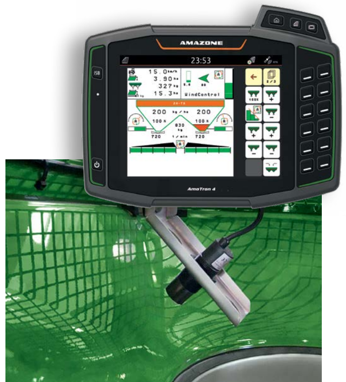
✔ Sensor för tom behållare i ZA-TS
