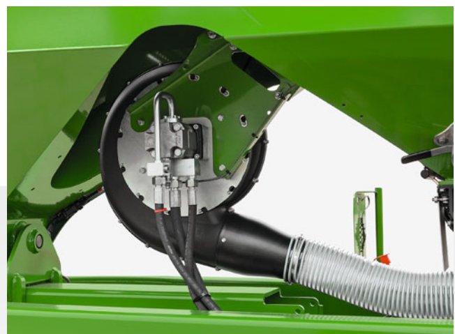
Hydraulic blower fan drive
